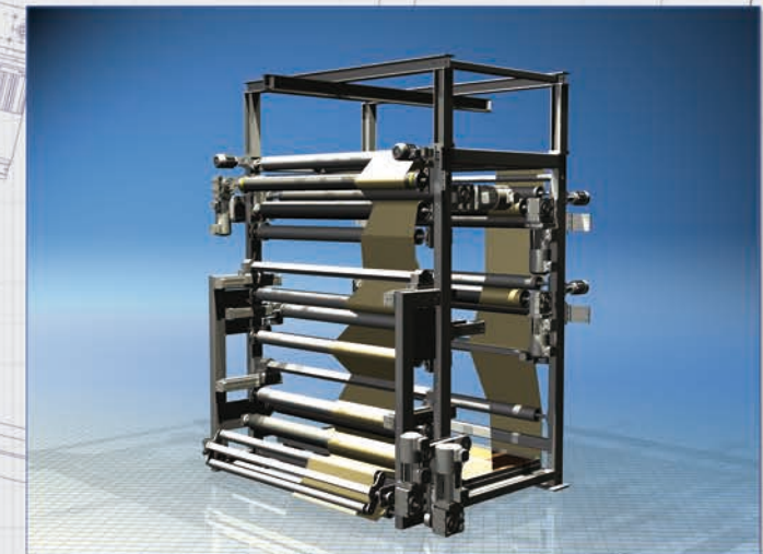
3D Konstruktion Schabmaschine
